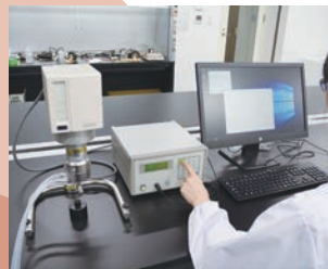
▲溶剤の流動性や保存時の安定性を確かめる事を目的とした粘度計
