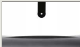
※施工済ガラス面の水接触角
