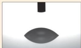
※未施工ガラス面の水接触角
