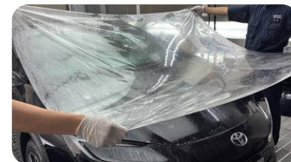
プロテクション フィルム施工の様子
