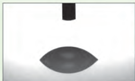
※未施工ガラス面の水接触角
