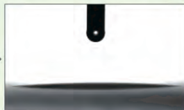
※施工済ガラス面の水接触角
