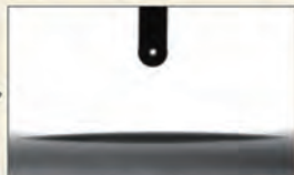
※施工済ガラス面の水接触角
