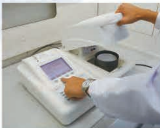
●各温度における溶剤の揮発速度を測定できる揮発分・固形分測定器
