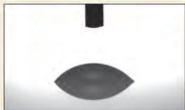
※未施工ガラス面の水接触角
