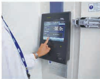
●マイナス30℃の環境を作り出し、雪国の再現もできる恒温恒湿室を新設
