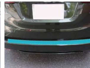
●「C.A.Wボディプロテクションフィルム」パーツ別に展開／左から「ドアノブ奥」「ドアミラー」「フロントバンパー」「リアバンパーステップ」
