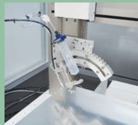
▲立体物へのコーティング施工も可能な卓上型スプレー塗布機
