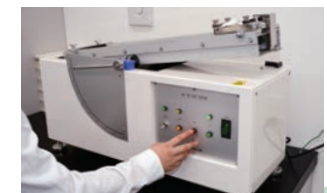
▲水滴の落下角を検証するスリップテスター
