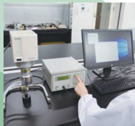
▲溶剤の流動性や保存時の安定性を確かめる事を目的とした粘度計
