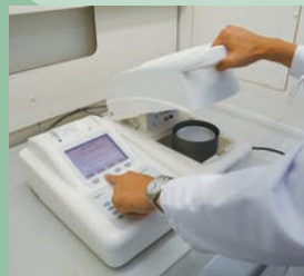
▲各温度における溶剤の揮発速度を測定できる揮発分・固形分測定器
