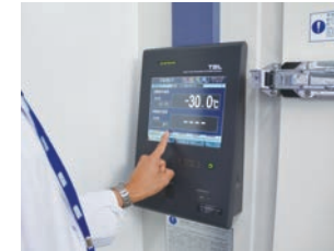
▲マイナス30℃の環境を作り出し、雪国の再現もできる恒温恒湿室を新設
