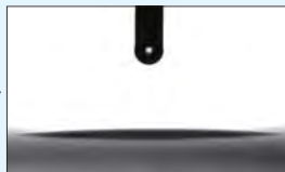
※施工済ガラス面の水接触角
