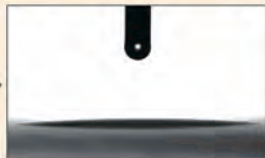
※施工済ガラス面の水接触角
