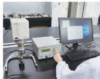
● 溶剤の流動性や保存時の安定性を確かめる事を目的とした粘度計
