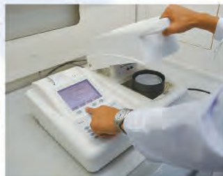
● 各温度における溶剤の揮発速度を測定できる揮発分・固形分測定器
