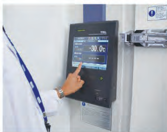
● マイナス30°Cの環境を作り出し、雪国の再現もできる恒温恒湿室を新設
